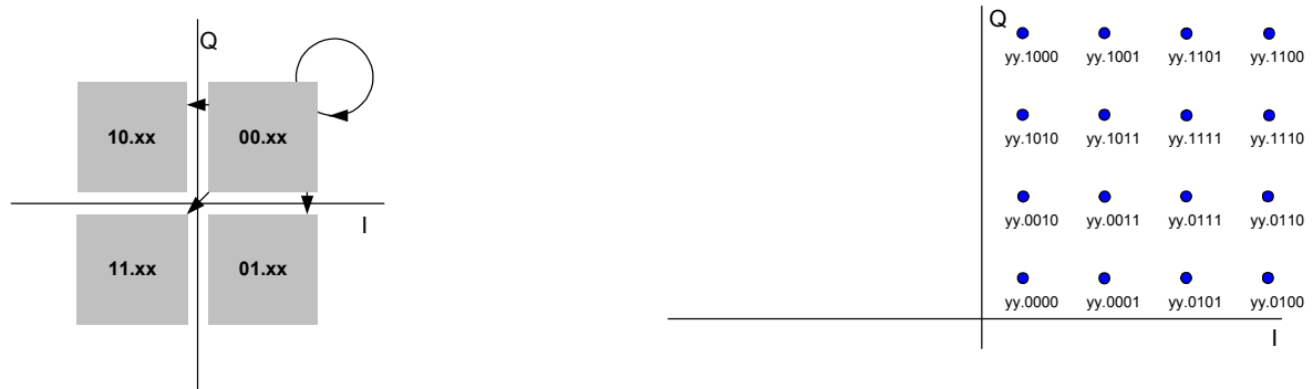
Bild 74 Symbolmapping D64 QAM / DVB-C
