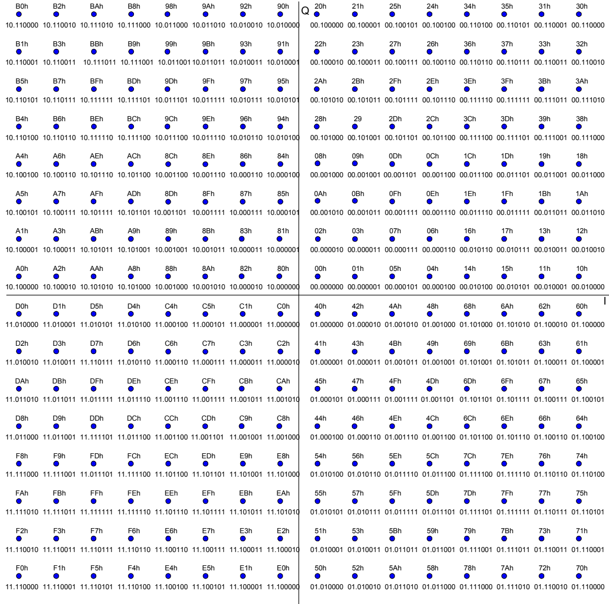
Bild 71 Symbolmapping 256 QAM / DVB-C
